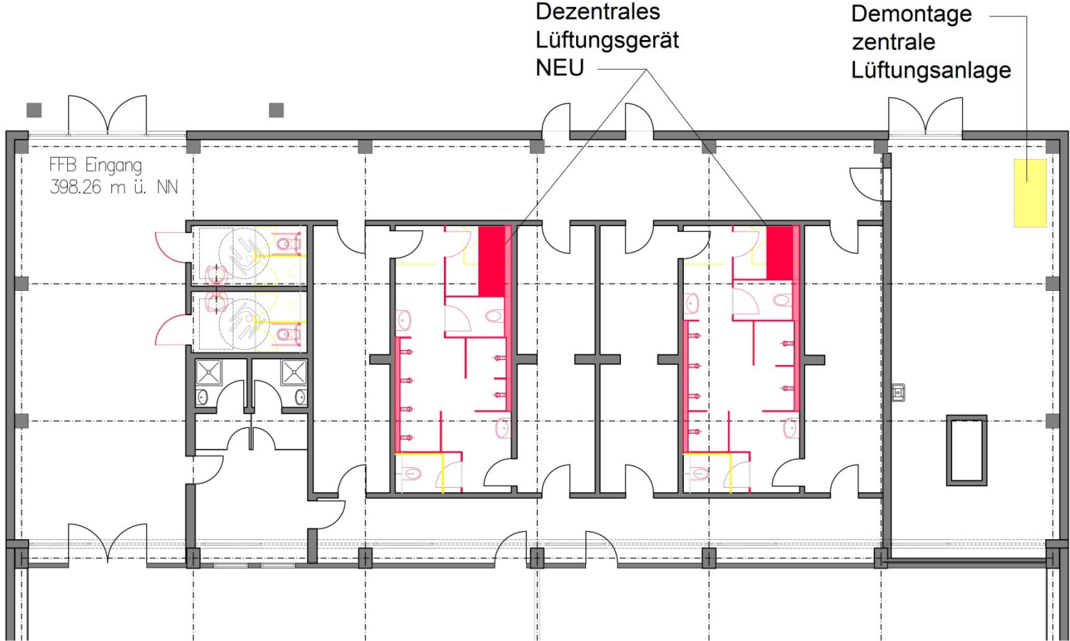
Austausch der zentralen Lüftungsanlage gegen dezentrale Geräte mit Wärmerückgewinnung
