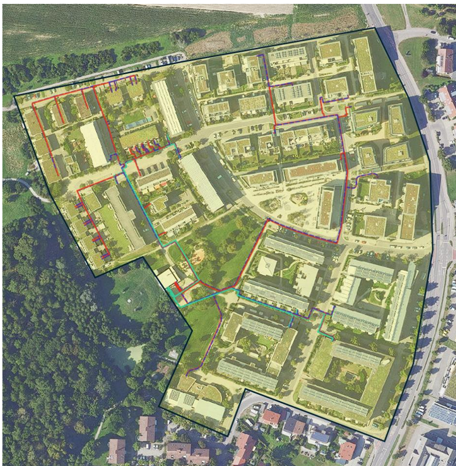
Abbildung 1 Aktuelles Versorgungsgebiet des Nahwärmenetzes Wiggenhausen
