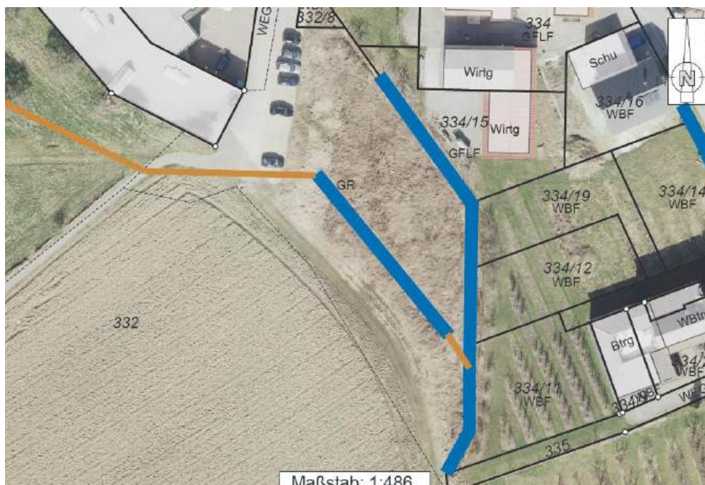
Abb. 10: Gewässernetz im südöstlichen Plangebiet (blau = Entwässerungsgraben, braun = verdolter Graben), Quelle: LRA Bodenseekreis
