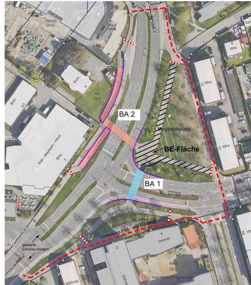
Bauabschnitte 1 und 2 der unteren Verkehrswege für den Geh- und Radverkehr
